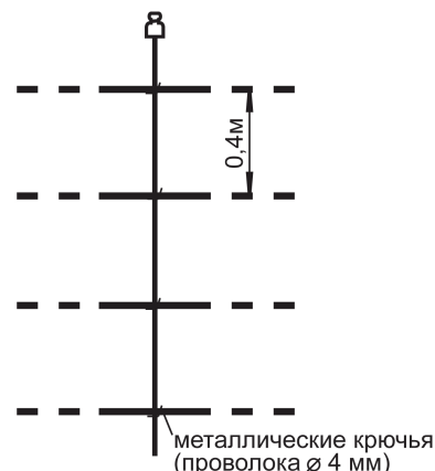
Рисунок А. 2 – Рейка с антенными проводами (вид спереди)
